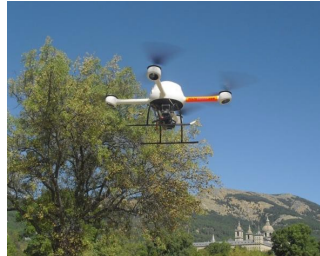
Cuadricóptero Motor eléctrico Carga de pago: 0,2 kg Autonomía: 15 min.
