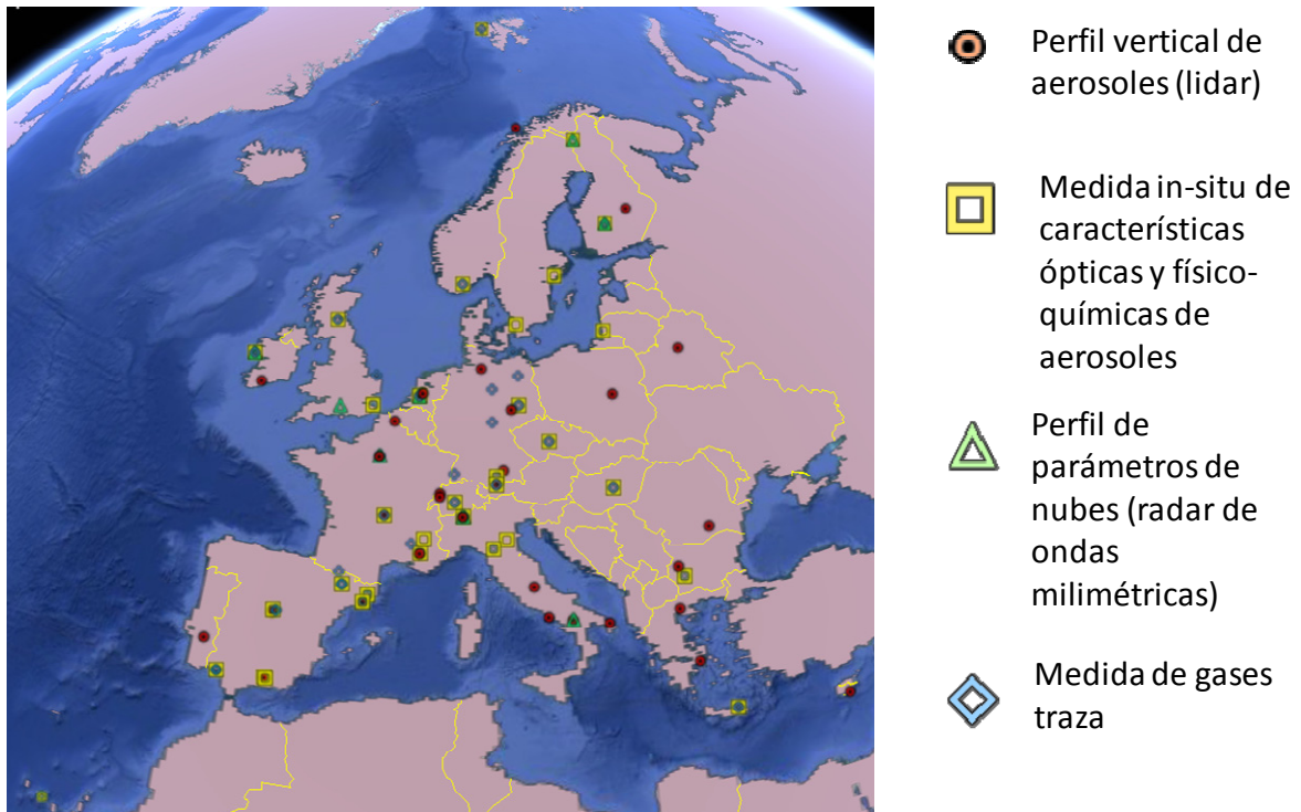
Fig. 2. Infraestructura actual de observación de ACTRIS
