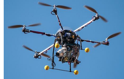
Hexacóptero Motor eléctrico Carga de pago: 2,5 kg Autonomía: 25 min
