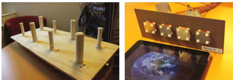
Fig. 14. Pruebas de campo con terminales tipo tablet de MIMO con 8 capas físicas.
