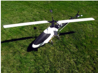
Helicóptero Motor de combustión Carga de pago: 3 kg. Autonomía: 60 min.
